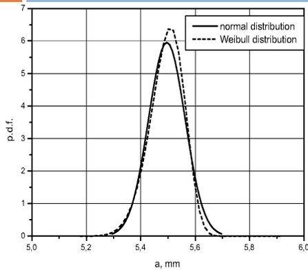
Fig. 1. P. d. f. of final crack depth  $a_f$ ,  $a_0=5$  mm
