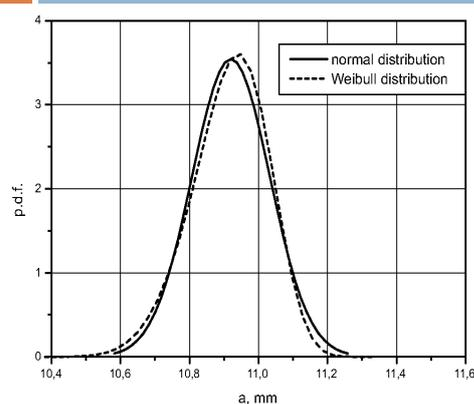
Fig. 1. P. d. f. of final crack depth  $a_f$ ,  $a_0=10$  mm
