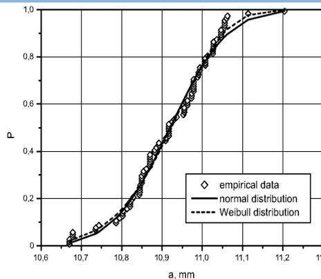
Fig. 2. C. d. f. of final crack depth  $a_f$ ,  $a_0=10$  mm
