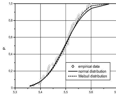
Fig. 2. C. d. f. of final crack depth  $a_f$ ,  $a_0=5$  mm
