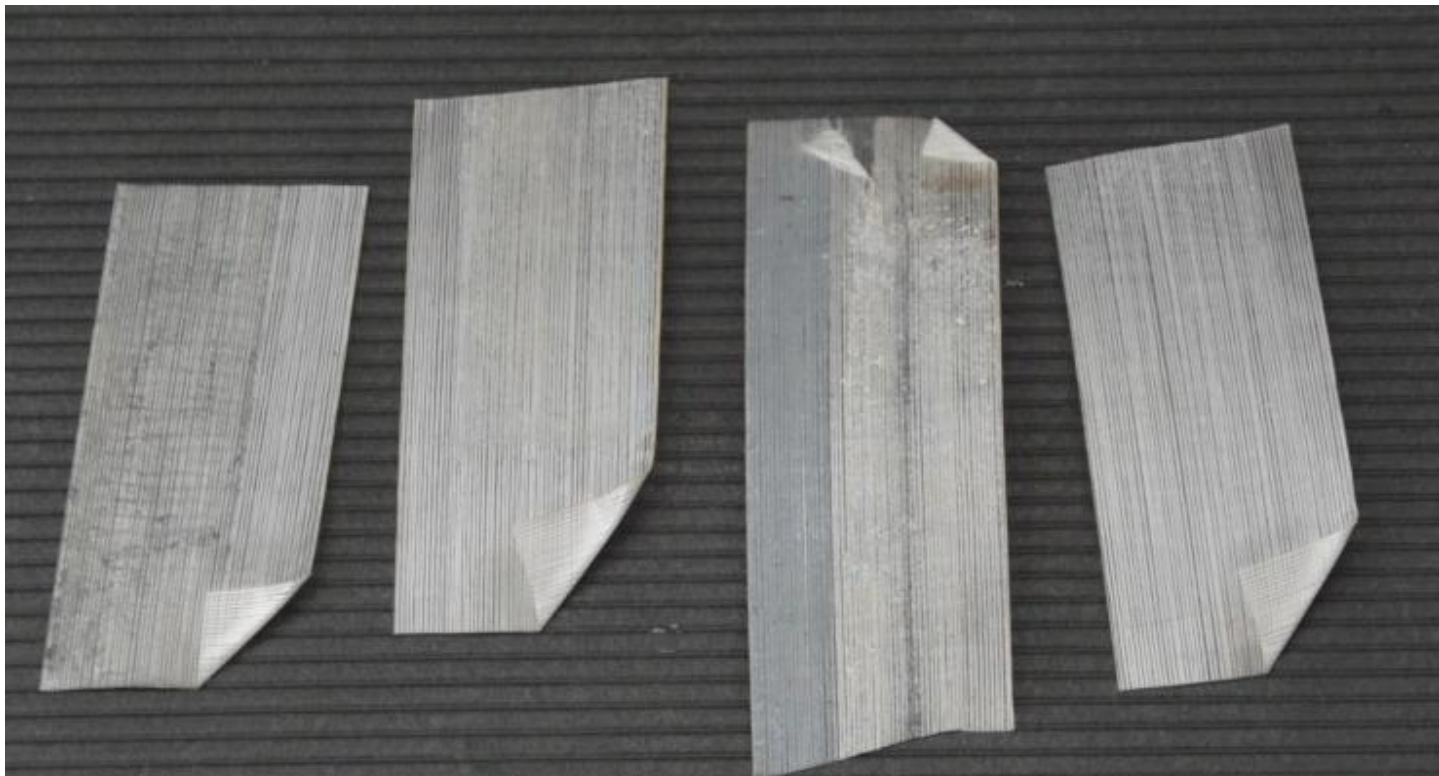
Rysunek 1. Próba odrywania. Na taśmach celulozowych można zaobserwować oderwane tlenki cynku
